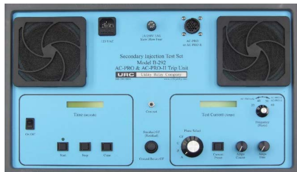
Figura 15.1: Conjunto de teste de injeção secundária B-292
